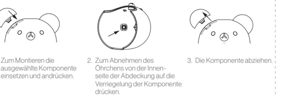
1. Zum Montieren die ausgewählte Komponente einsetzen und andrücken.
